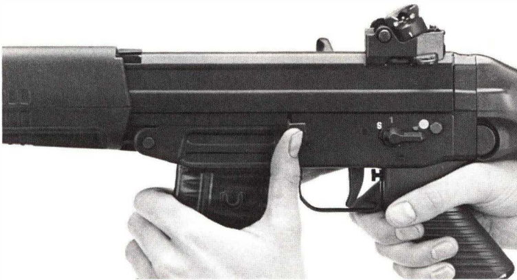
Hochdrücken des Verschlusshalters
