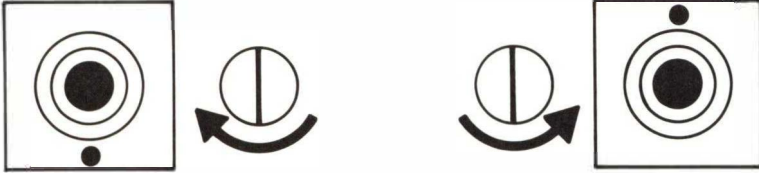
Korrektursymbol am Visier (Höhenkorrektur)
