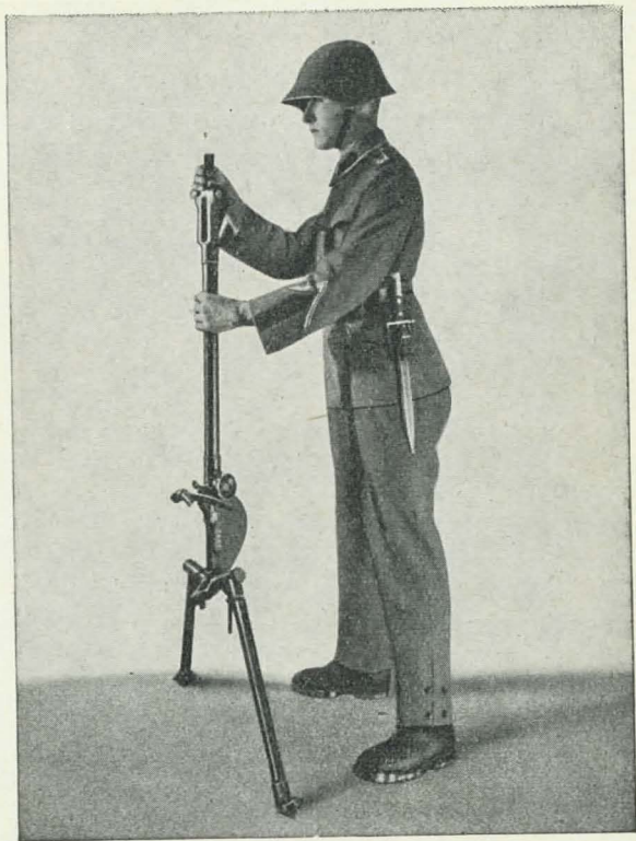
Mise en position du trépied du fm. pour le tir contre avions
